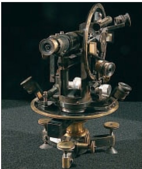
Universaltheodolith, Starke & Kammerer, Wien, 19. Jh.
